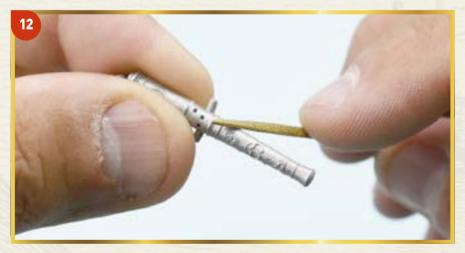
12 Надфилем обработайте ствол и дельфины (две ручки) ствола, чтобы убрать возможные дефекты.
