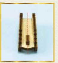
11 Вырежьте подъемный клин пушки и приклейте его на лафетную раму строго по центру и в 2 мм от заднего закругленного края.
